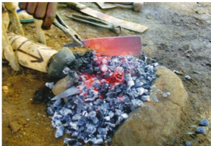
Figure 2 : Le forgeron Téké récupère le fer du foyer pour le marteler.
