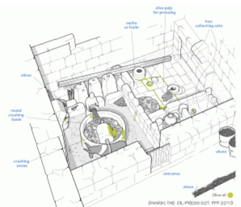
**Fig. 4. Proposition de restitution du fonctionnement de l'huilerie construite à l'époque protobyzantine dans l'ancien sanctuaire nabatéen de Dharih. Etape 1 : le broyage des olives avant le pressurage des courtins. Dessin PPF 2012.**
