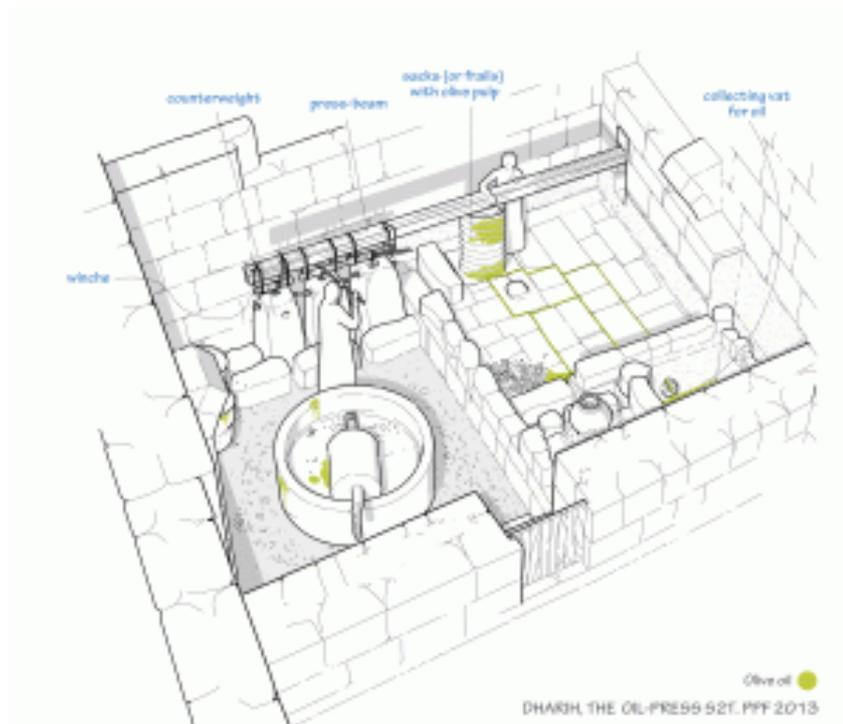
**Fig. 5. Proposition de restitution du fonctionnement de l'huilerie construite à l'époque protobyzantine dans l'ancien sanctuaire nabatéen de Dharih. Etape 2 : le pressurage des courtins avant le raffinage de l'huile extraite. Dessin PPF 2012.**
