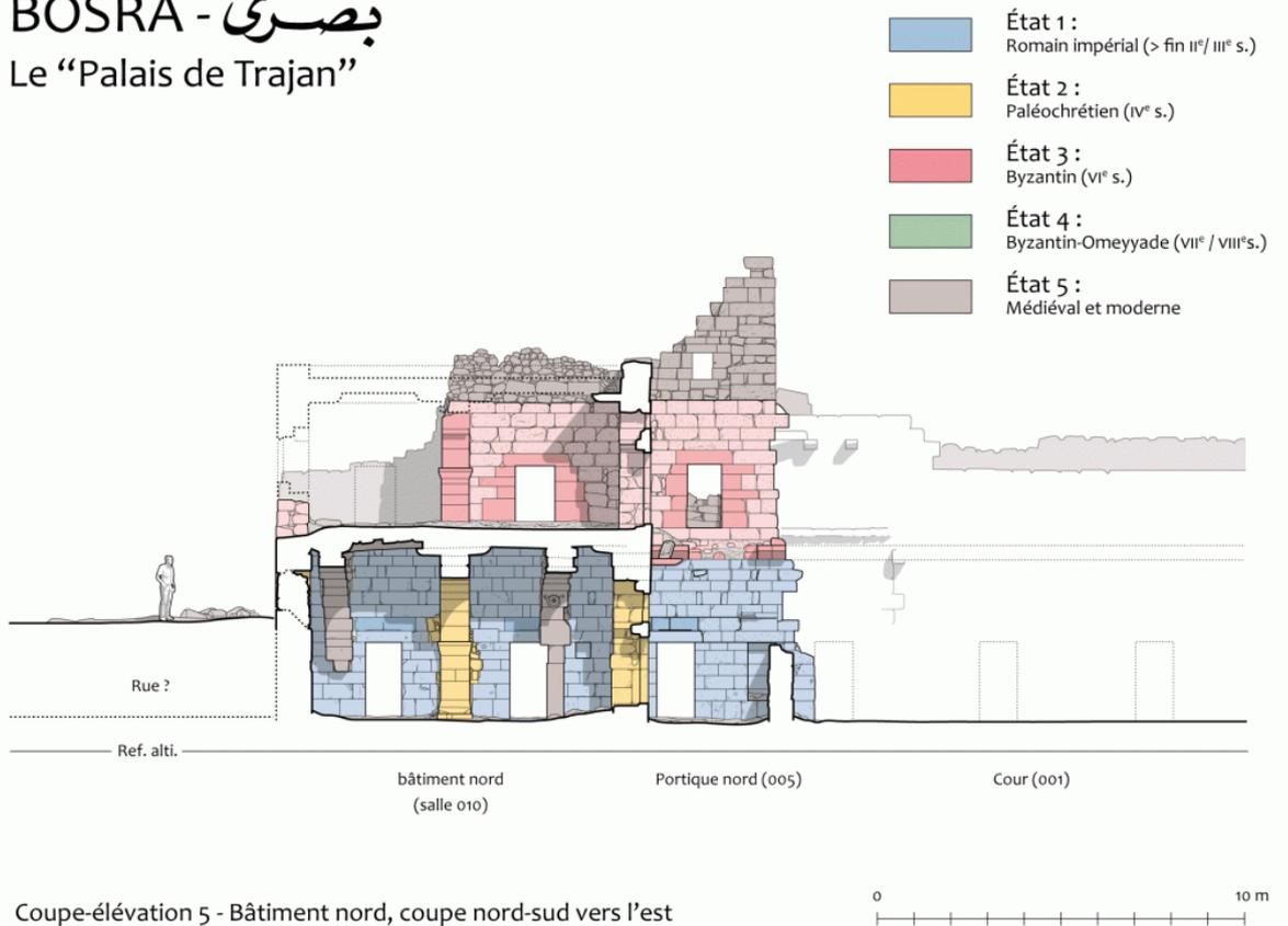
**Fig. 3. Relevé des façades du « Palais de Trajan », grande résidence d'époque protobyzantine de Bostra, en Syrie du Sud. Analyse archéologique du bâti et étude des techniques de construction. Dessin PPF 2016.**
